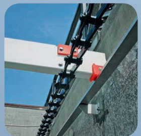
НАПРАВЛЯЮЩАЯ ОБРАТНОГО ХОДА БАЛКИ ИЗ СП СО СКОльзяЩИМ БАШМАКОМ
