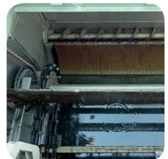
Илоскребы DAF со шнековой выгрузкой масла
